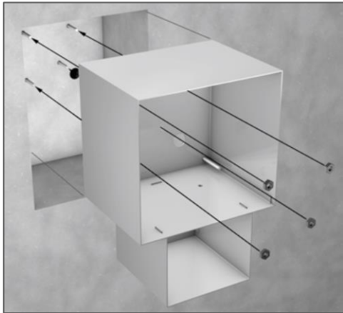
Abb. „Montage der Zarge“
