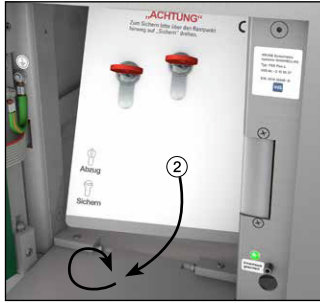
② OSÜ-Innenblech mit der Unterseite nach vorne kippen, vorsichtig herausziehen und umdrehen.
